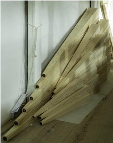
Foto: Die Becher des rekonstruierten Registers „Posaune 16 Fuß“ vor dem Einbau in die Orgel
